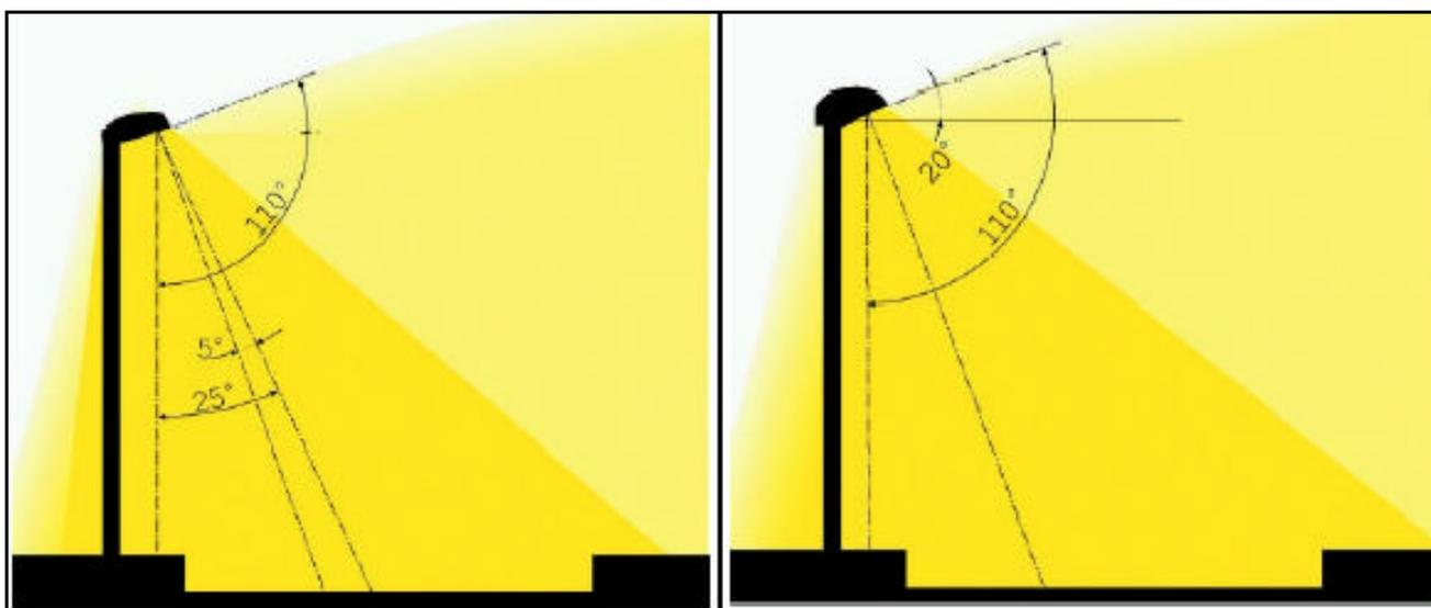
Figura 10 - Installazione non conforme
