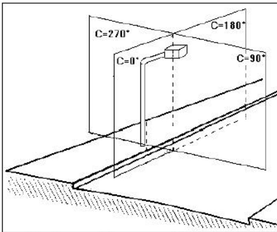
*Figura 4 - Piani fondamentali utilizzati per le misurazioni di un apparecchio d'illuminazione.*
