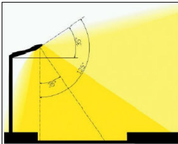
Figura 12 - Installazione non conforme LR n°37/2000
