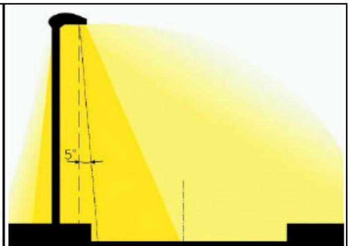
Figura 9 - Installazione non conforme LR n°37/2000
