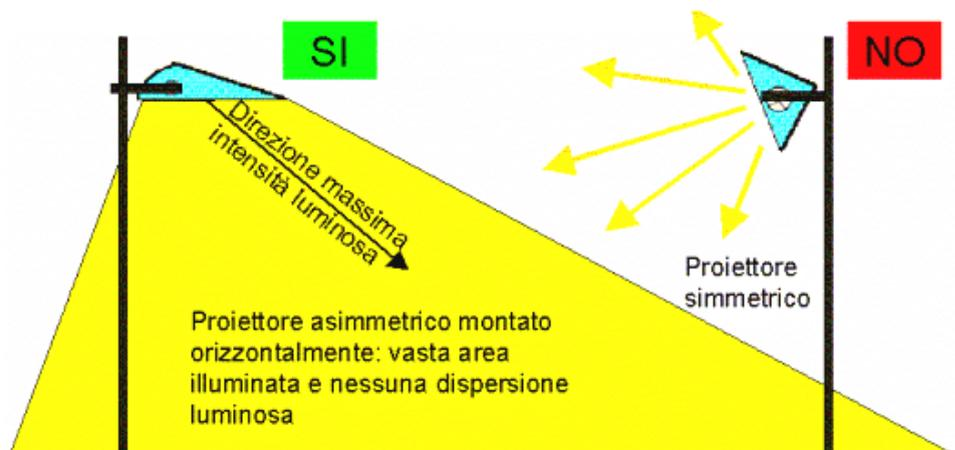
Figura 14 - Schema di funzionamento dei proiettori. La posizione di montaggio ottimale è a  $0^\circ$  rispetto al piano orizzontale, in questo modo non si ha dispersione di luce verso l'alto e si sfrutta la massima funzionalità del corpo illuminante.
