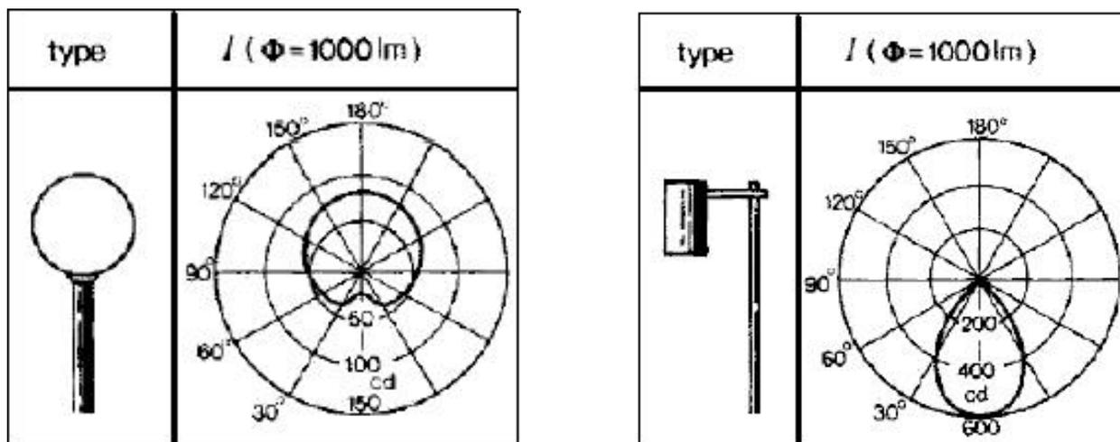
Figura 5 – Curve fotometriche di due tipologie di sistemi di illuminazione: globo luminoso (a sinistra) e lampione schermato (a destra).
